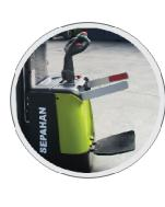
\* سیستم کنترل هیدرولیک کمک می‌کند تا موقعیت دقیق شاخک‌ها را در حین بالا و پایین بردن بار کنترل نماید تا تغییر سرعت شاخک‌ها در حین بالابردن کالاهای شکستنی به طور ملایم انجام گیرد.
