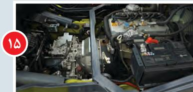
کنترل الکترونیکی سلامت موتور و ترانسیمیشن ناشی از دما؛ چنانچه دمای موتور یا ترانسیمیشن از حد مجاز تجاوز کند یا فشار روغن موتور کاهش یابد، پیش از آسیب، لیفتراک خاموش می شود.
