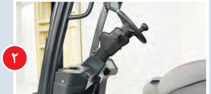
قابلیت تنظیم ستون فرمان با زاویه وسیع با بکارگیری مکانیزم مفصلی- فنری، ستون فرمان می تواند با توجه به راحتی راننده، در طیف زاویه ای وسیعی تنظیم گردد.
