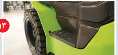
پایه رکاب ها از ورق مستحکم آج دار ساخته شده که موجب عدم لغزش راننده حین سوار شدن و پیاده شدن از لیفتراک می شود.
