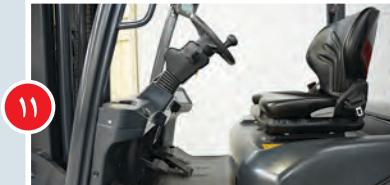
صندلی ارگونومیک راحت که متناسب با وزن راننده تنظیم شده و باعیات به حرکت طولی و تغییر زاویه پشتی بهترین حالت ممکن را برای راننده مهیا می کند. این صندلی فندردار بوده و از انتقال لرزش به راننده ممانعت بعمل می آورد.
