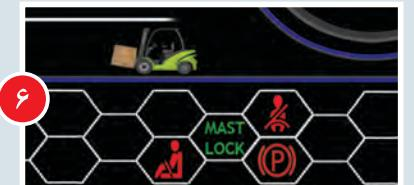
سیستم OSS (Operator Sensing System) با بلند شدن اپراتور از روی صندلی، حتی اگر در حرکت به سمت جلو یا عقب باشد، دنده به حالت خلاص درآمده و لیفتراک متوقف می شود.
