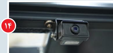
با بهره گیری از علم پردازش تصویر و نصب دوربین مربوطه، راننده دید ۳۶۰ درجه پیدا کرده و همچنین با نزدیک شدن افراد به لیفتراک، به راننده هشدار داده می شود.
