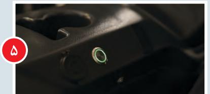
ترمز پارک الکتریکی (Negative Brake) با بلند شدن اپراتور از روی صندلی یا خاموش شدن لیفتراک، ترمز پارک فعال می شود.
