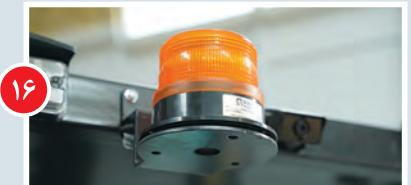
استفاده از چراغ های LED، Blue Light و چراغ گردان؛ با بهره گیری از LED های پر نور در چراغ های جلو و عقب، همچنین استفاده از Blue Light و چراغ گردان، حضور لیفتراک در هر مکانی برای اطراحی آشکار خواهد بود.
